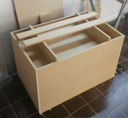
Base con los primeros contrafuertes colocados.
