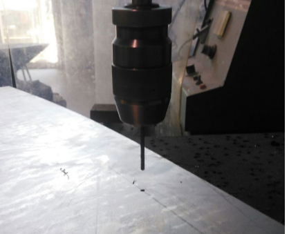
Perforación de las planchas de hierro.
