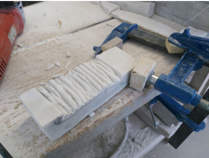
Hendiduras con radial para devastar el material sobrante
