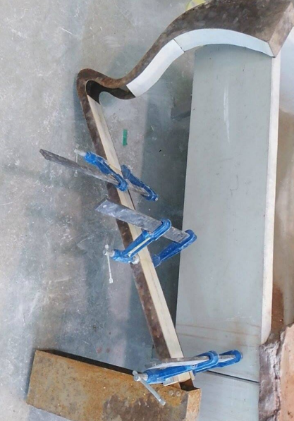
Pruebas de colocación de las piezas con sargentos.
