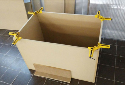
Planchas sujetas con escuadras.
