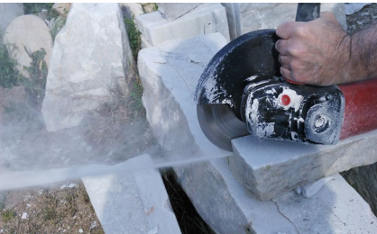
Corte con Radial de las piezas de mármol que constituyen el pie del Harphydrophone.
